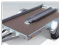
Befestigung der Auffahrschienen auf der Siebdruckbodenplatte.
