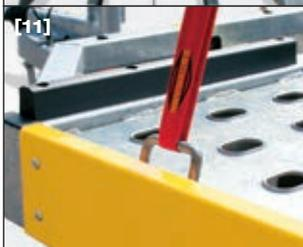
**Sicher unterwegs:** Mit vier Zurrbügeln zur Transportsicherung Ihrer Ladung. Alle Zurrbügel lassen sich mittels Feder klapperfrei in der Ladefläche versenken. Der massive Gummibalken dient als Radstopper.
