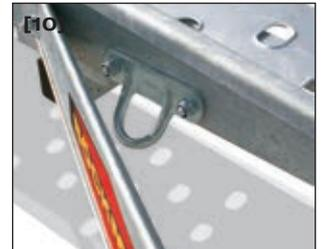
... und vorne an zwei starren Verzurrösen (am Radstopper montiert).
