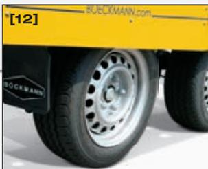
**Gut Verladen. Gute Fahrt:** durch den Einsatz der serienmäßigen 13"-Niederflurbereifung verfügen die AH-Modelle über einen niedrigen Schwerpunkt, für hohe Laufruhe und optimale Fahreigenschaften.
