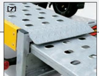
**Entspannt ankommen:** Die neuartigen Klemmverschlüsse sichern optimal die Auffahrstufen. – Und das klapperfrei, für eine geräuschkonforme und vor allem nervenschonende Fahrt.
