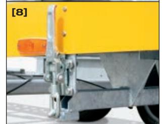
**Durchdacht bis ins Detail:** Die Begrenzungsleuchten sind in flexiblem Gummi gefasst, für ein beschädigungsfreies Rangieren. Ein weiterer Vorteil: Bei einer Verladung bei Nacht bleibt Ihr Fahrzeug immer sichtbar.
