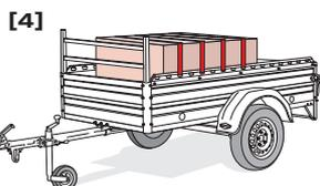
**Für alle Fälle:** Die in den Bordwänden integrierte Verzurrungsgalerie ermöglicht ein punktgenaues Sichern der Fahrzeuge oder anderer Ladung, für einen sicheren Transport.
