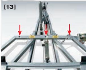
**Alles im Griff:** Mit der bereits serienmäßig installierten, stabilen Seilwinde (mechanisch) mit Windenbock und Umlenkrolle (3-fach über die gesamte Ladebreite verstellbar), für ein bequemes und sicheres Be- und Entladen.
