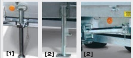
**Doppelt hält besser:** Entscheiden Sie sich für ausziehbare Schiebestützen [1] oder für schwenk- und ausdrehbare Teleskopkurbelstützen [2].
