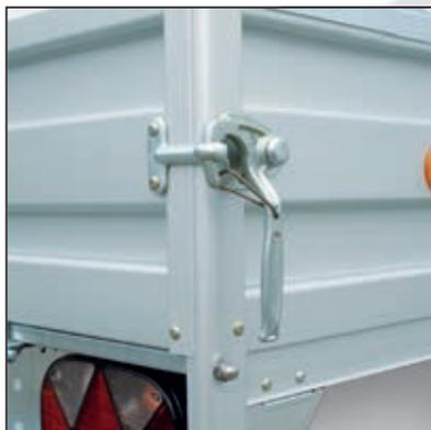
**Sicher verladen:** Mit den großen, massiven Winkelhebelverschlüssen ist ein schnelles Be- und Entladen möglich.
