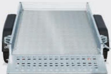
**Für härteste Einsätze:** Die Siebdruckbodenplatte verstärkt mit Alu-Riffelblech für extreme Belastungen und ein rutschsicheres Be- und Entladen.
