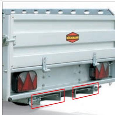
**Gut verstaut:** Die Schienen werden komfortabel in zwei Schienenmagazinen gesichert.
