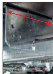
Achsauflage & Auflagebock 3-fach verschraubte, breite Achsauflagen und breite Achsauflegeböcke unter der Bodenplatte für optimale Stabilität
