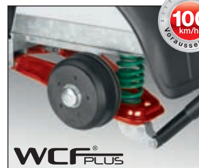
WCFplus-Fahrwerk World-Class-Fahrwerk nach Automobilstandard (WCFplus) für sensible Transportgüter (Zubehör)
