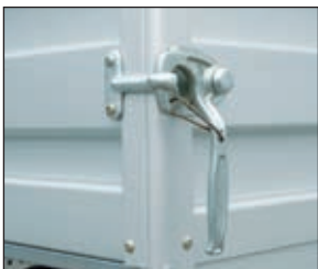
Verschluss Winkelhebelverschluss – leicht und schnell bedienbar
