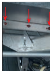
Achsauflage & Auflagebock 3-fach verschraubte, breite Achsauflagen und breite Achsauflegeböcke unter der Bodenplatte für optimale Stabilität
