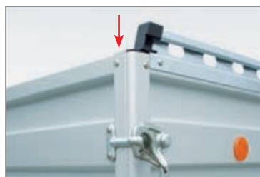
Hinterklappe Stabile Fixierung der Hinterklappe zwischen Seitenwänden
