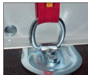
Verzurrösen Die Verzurrösen ermöglichen ein optimales Sichern der Ladung (4 Stück bis Innenlänge 2515 mm, 6 Stück ab Innenlänge 3015 mm)
